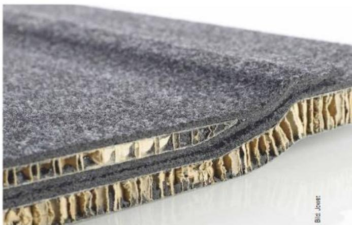
Bei der Klebung eines Ladebodens wird GMPU mit einem Polyurethan-Hotmelt mit dem Teppich kaschiert
